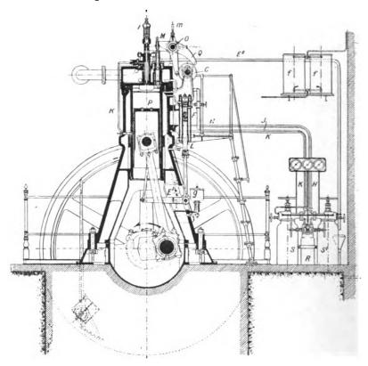
FIG. VI.-3. Transverse section (Diesel Engine).
