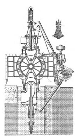
FIG. X11.-12. Cockerill Girder-type Frame.
