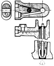
tion Valve Box (Diesel Engine).
