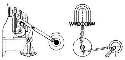
FIG. X.—13. Magneto mechanism, Gasmotoren Fabrik Deutz.
