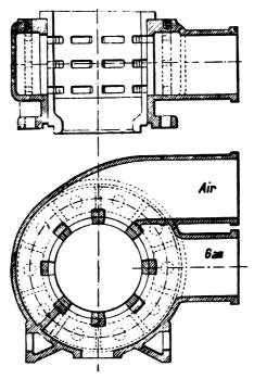
FIG. XI.-42. Elsassische Mixing Valve Box.
